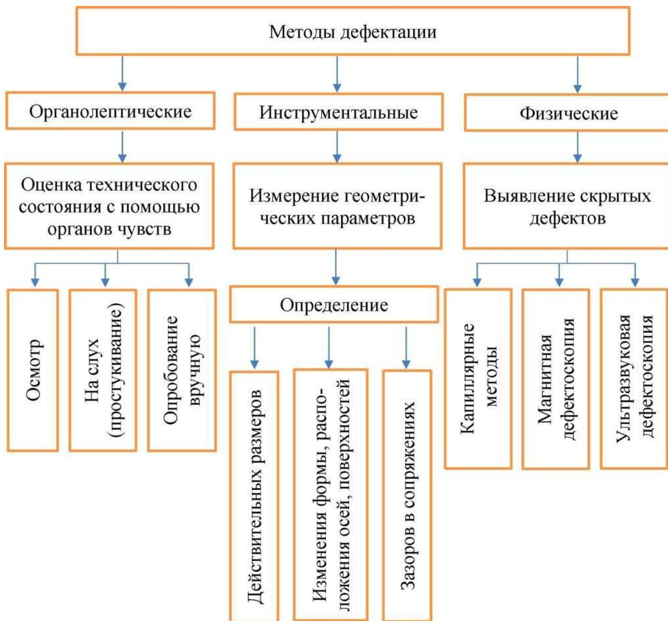
Рис. 14. Классификация методов дефектации
