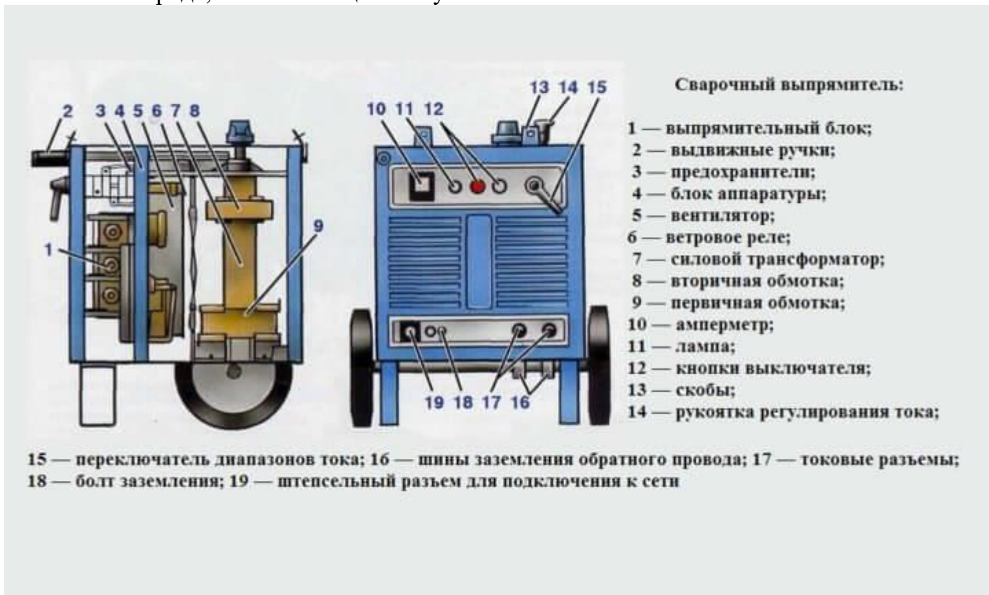
Устройство сварочного выпрямителя
