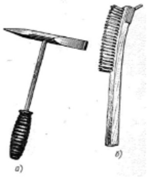
Рис. 2. Инструмент для зачистки шва и свариваемых кромок
