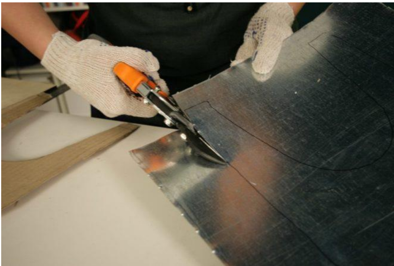
При резке металла делают припуски для зачистки и разделки кромок
