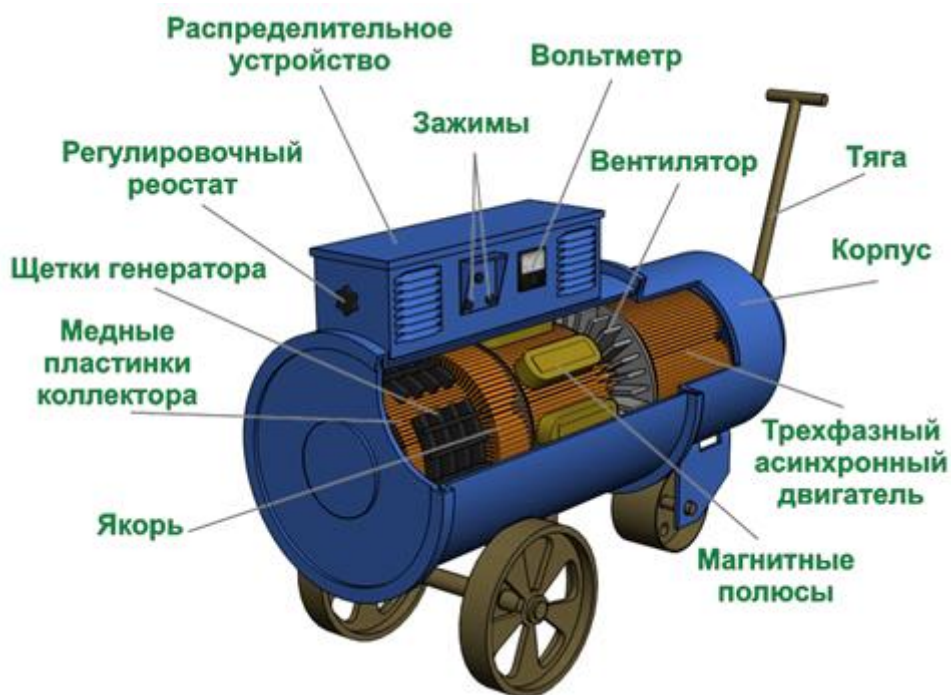
Устройство сварочного преобразователя ПСО-500
