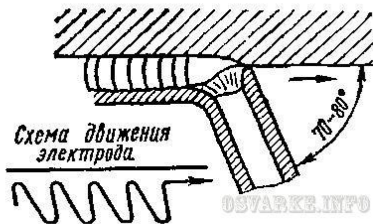
Рис. 32. Сварка потолочных швов
