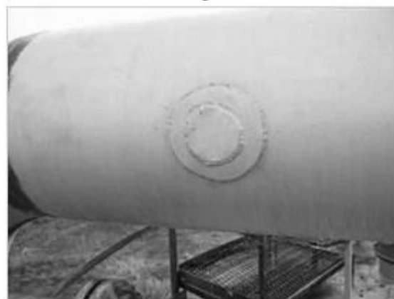
Рис 2. Примеры дефектов трубопроводов, обнаруживаемых при визуальном осмотре: а – сварные секционные отводы, б – сварные переходники, в – приварка патрубков без усиливающего воротника, г - заплата
