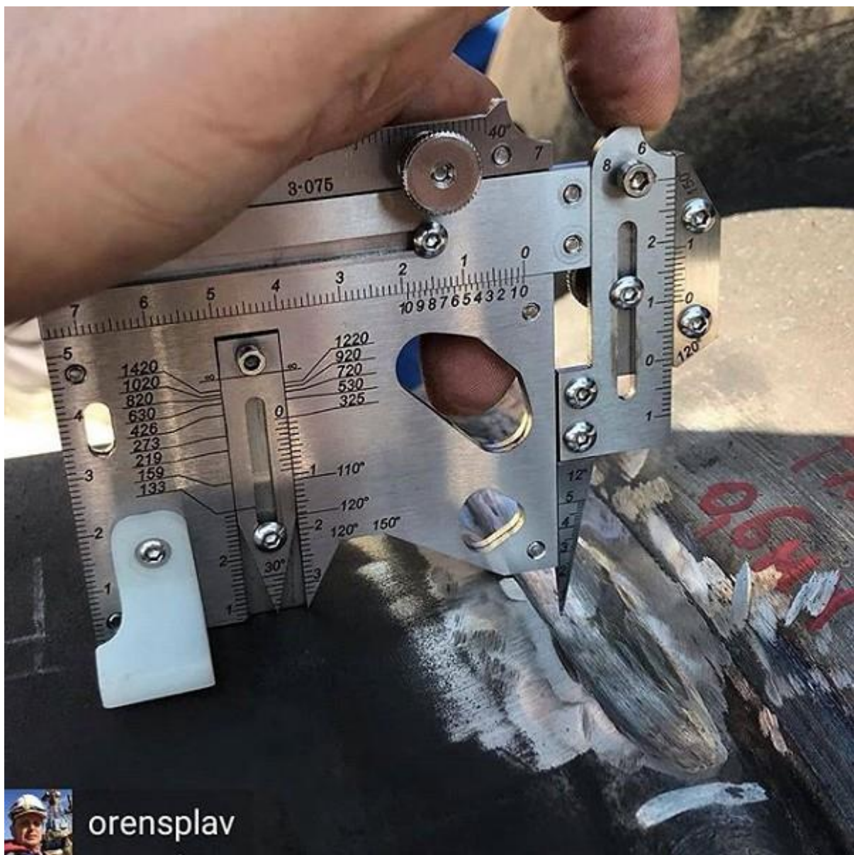
Рис. 4. Универсальный шаблон специалиста неразрушающего контроля
